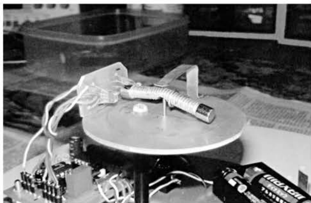
写真2 自作方位磁石部分
